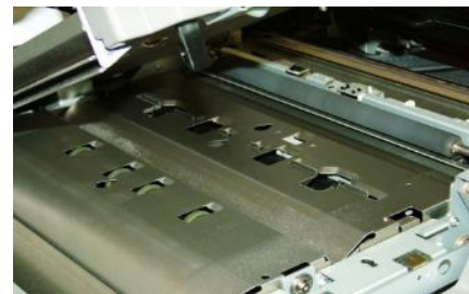
Una compuerta de registro endereza el papel y luego lo suelta a medida que la hoja avanza hacia el sensor de imagen por contacto para el ajuste adicional.
